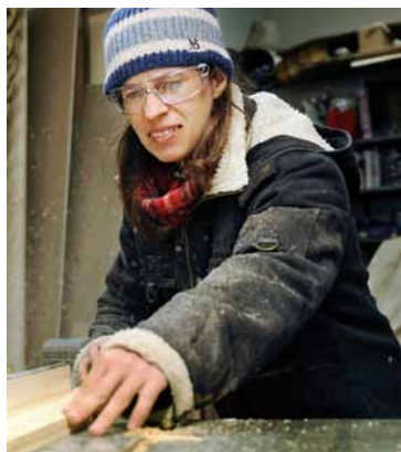
Le bois que Josée coupe sur le banc de scie servira à préparer les contours des fenêtres de l'immeuble d'aménagement St-Gelais, présentement en rénovation.
